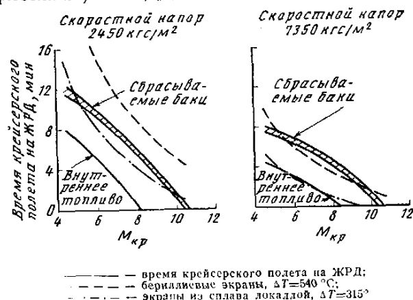
Фиг. 10. Зависимость времени крейсерского полета самолета HSRA от числа M полета (вес полезной нагрузки 680 \text{ кгс} )
