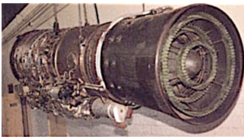
Рис.13. Двухступенчатая камера сгорания МиГ-21бис.
