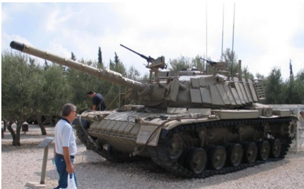
Рис.11. Танк МАГАХ-6, созданный израильтянами на базе американского танка М-60.
