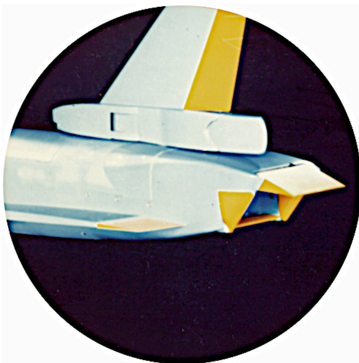
Рис. 15. Сопло ADEN на модели Х-29 в аэродинамической трубе.
