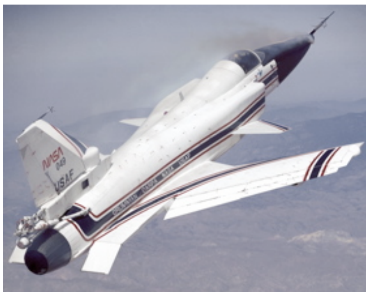
Рис.14. управление рысканием при помощи вдува азота в вихревую зону. Система VFC.
