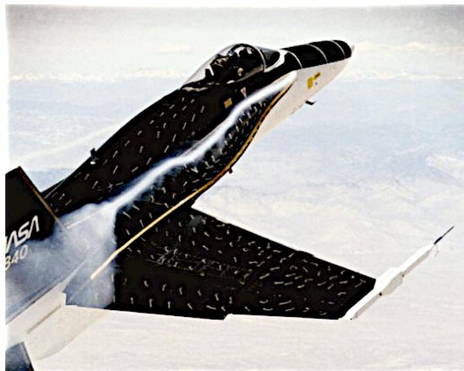
Рис. 14. Взрыв вихревого жгута и взаимодействие вихря с вертикальным килем.
