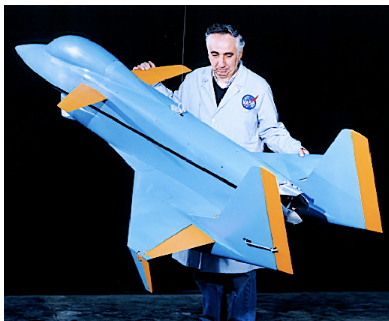
Рис. 16. Модель Rockwell SNAKE для испытания в аэродинамической трубе.
