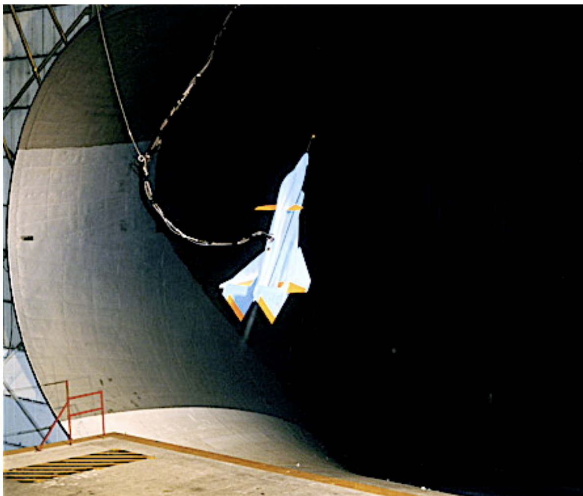
Рис. 18. Испытания “Змея” на больших углах атаки.
