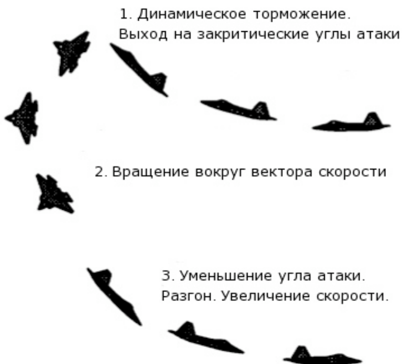
Рис. 8. Маневр “Динамический разворот”, использующий вращение вокруг вектора скорости.
