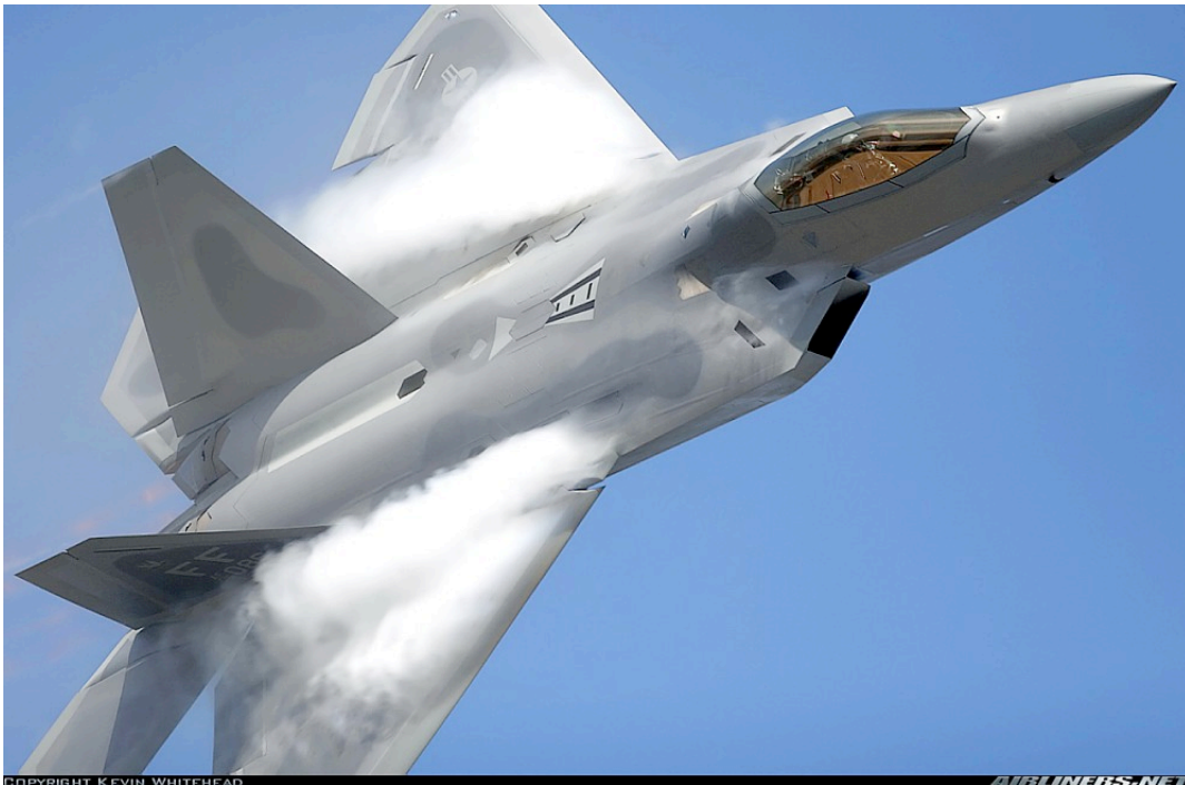
Рис. 4. Вихри, срывающиеся с передней кромки крыла
