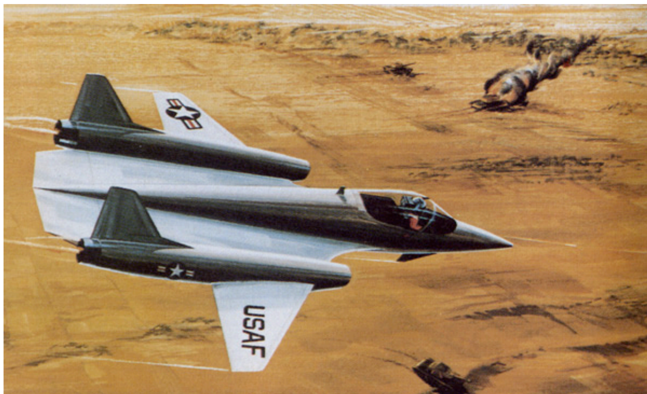
Рис.13. Рисунок экспериментального самолета AMDAC с непосредственным управлением боковой аэродинамической силой и эффектом суперциркуляции.
