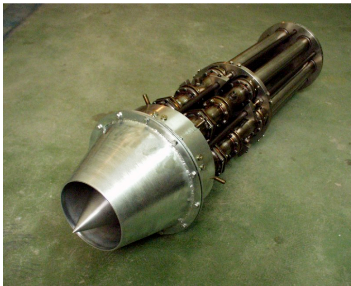
Рис. 12. Импульсно-детонационный двигатель (ИДД) традиционной схемы с пакетом детонационных труб в качестве резонаторов.
