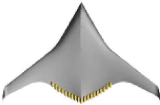
Рис.6. Распределенная силовая установка с множеством газогенераторов.
