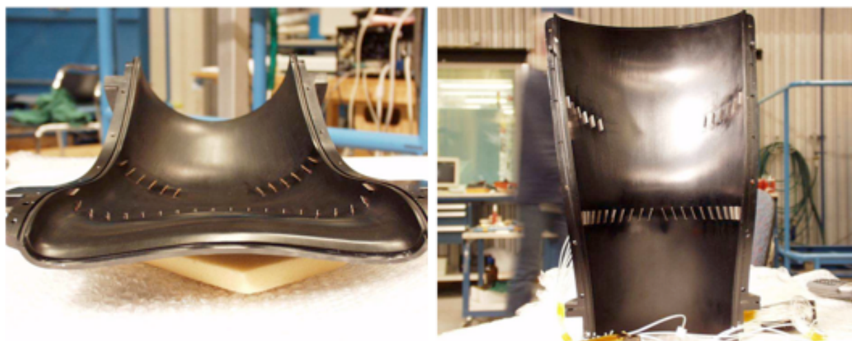
Рис.23. Малошумный дозвуковой воздухозаборник [7].
