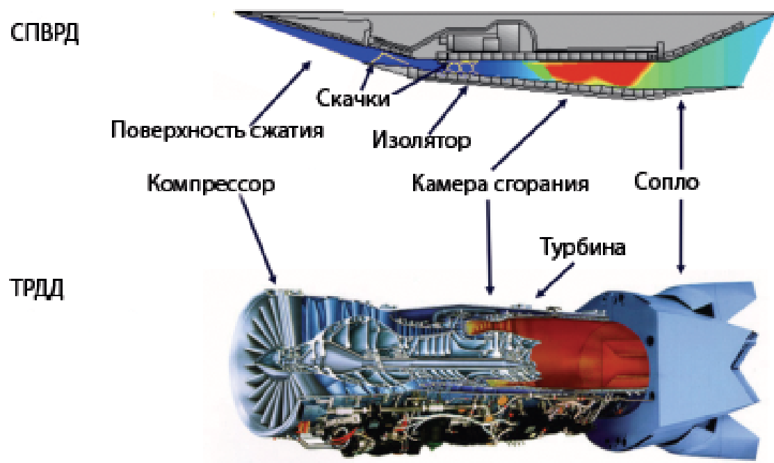
Рис. 5. Схема СПВРД и компоновка двухступенчатого воздушно-космического самолета
