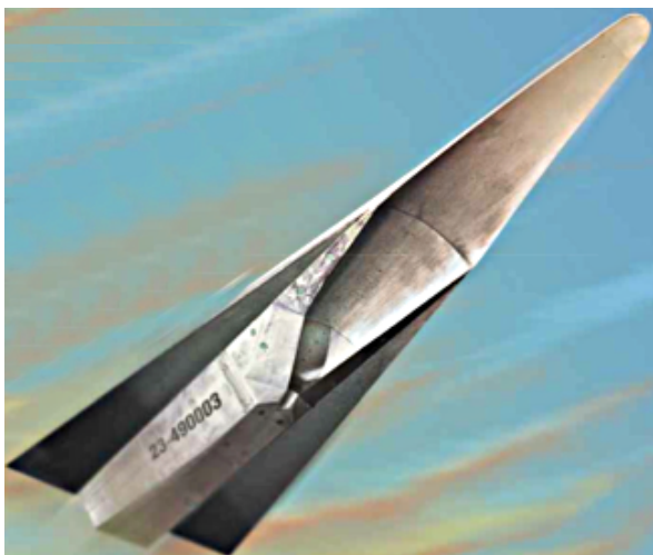
Рис.30. Продувочная модель ИТПМ с ковшовым воздухозаборником.
