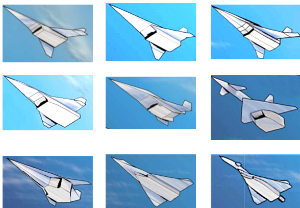
Рис.26. Классификация схем интеграции ВУ и планера гиперзвукового ЛА.
