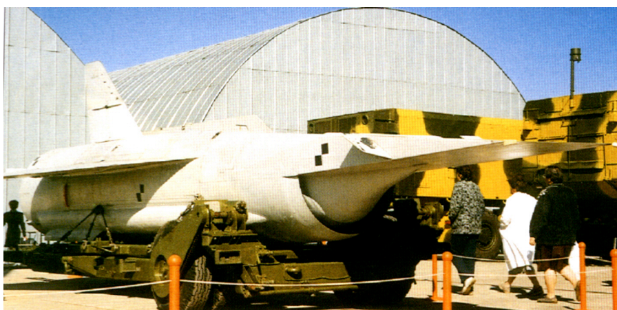
Рис. 27. Изоэнтропический воздухозаборник на ГПВРД экспериментального гиперзвукового аппарата «Радуга».
