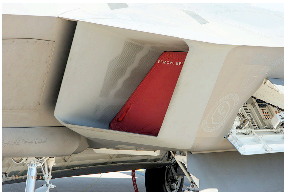
Рис. 19. Вихреобразующая кромка F-22, играющая роль наплыва.
