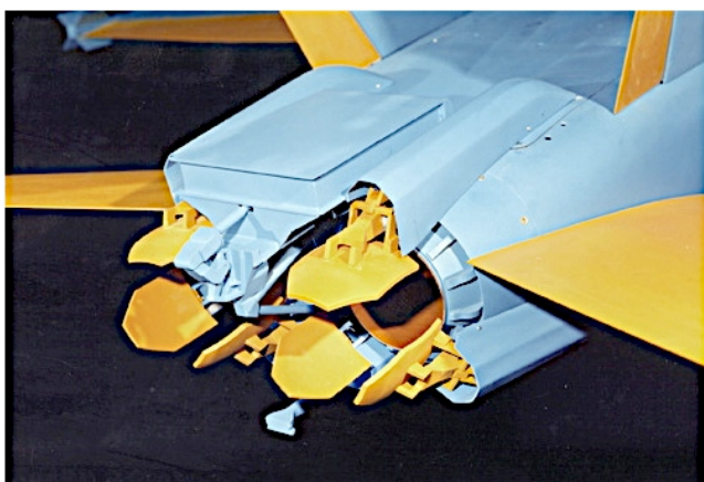
Рис.7. УВТ с дефлекторными панелями
